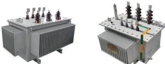
S(B)H15-M系列非晶合金变压器，铁心采用单框或三相五柱卷铁心，铁心夹紧采用薄板成型框架结构，低压线圈为箔绕式，使之损耗低、抗短路能力强、结构先进合理、总体性能指标达到世界先进水平。
