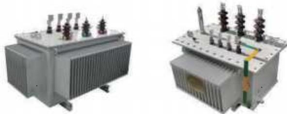
S(B)H15-M系列非晶合金变压器，铁心采用单框或三相五柱卷铁心，铁心夹紧采用薄板成型框架结构，低压线圈为箔绕式，使之损耗低、抗短路能力强、结构先进合理、总体性能指标达到世界先进水平。
